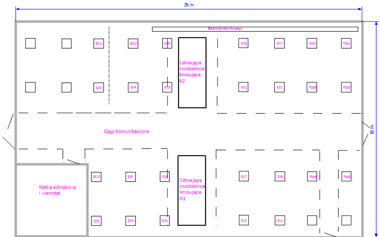
Rys. 1. Istniejące usytuowanie rozdzielnic i studzienek przyłączeniowych do zasilania stanowisk w hali laboratoryjnej H01
