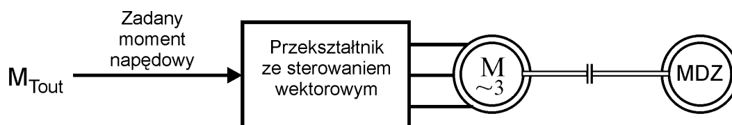
Rys. 7.2/13. Układ napędowy urządzenia WG2 z zaznaczeniem sygnału zadanego układu napędowego SAK
