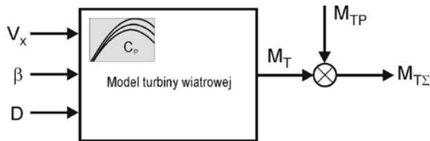
Rys. 7.2/9. Uwzględnienie efektu przystaniania masztu przez wprowadzenie momentu zakłócającego M_{T\Sigma}
