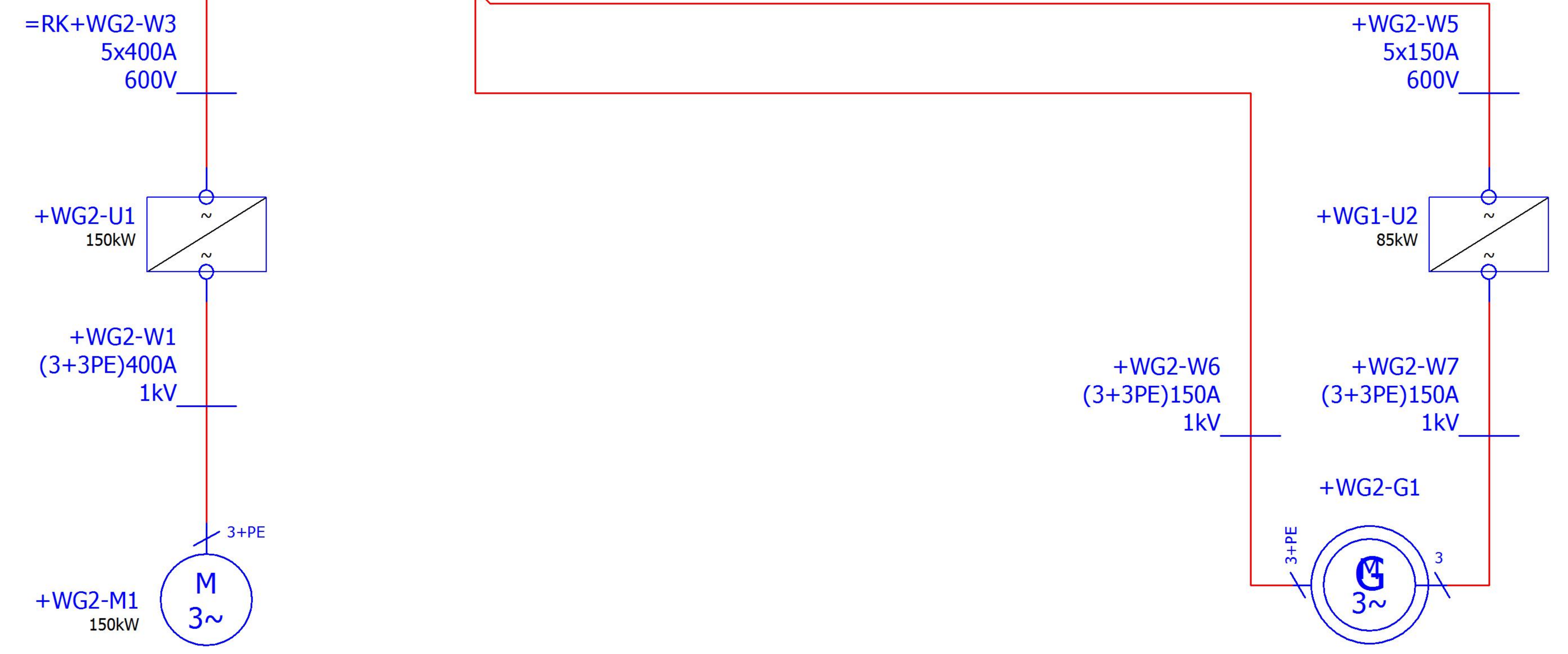
GENERATOR WIATROWY ASYNCHRONICZNY (WG2)
