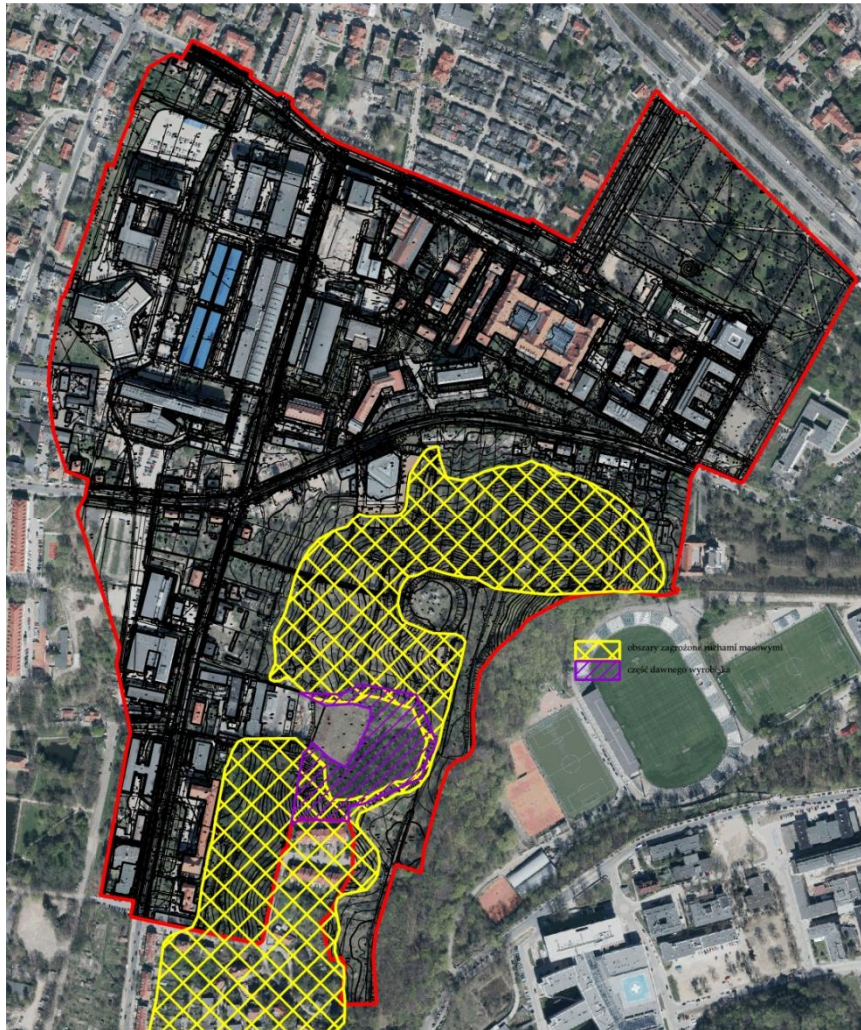
Rys. 5. Tereny zagrożone ruchami masowymi w rejonie analizowanego obszaru.
