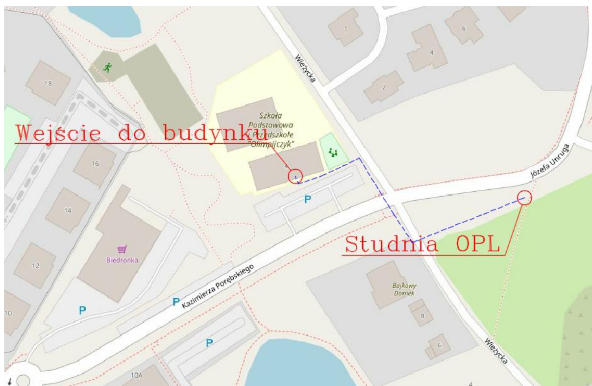
Rys. 6b. Poglądowa trasa przyłącza
