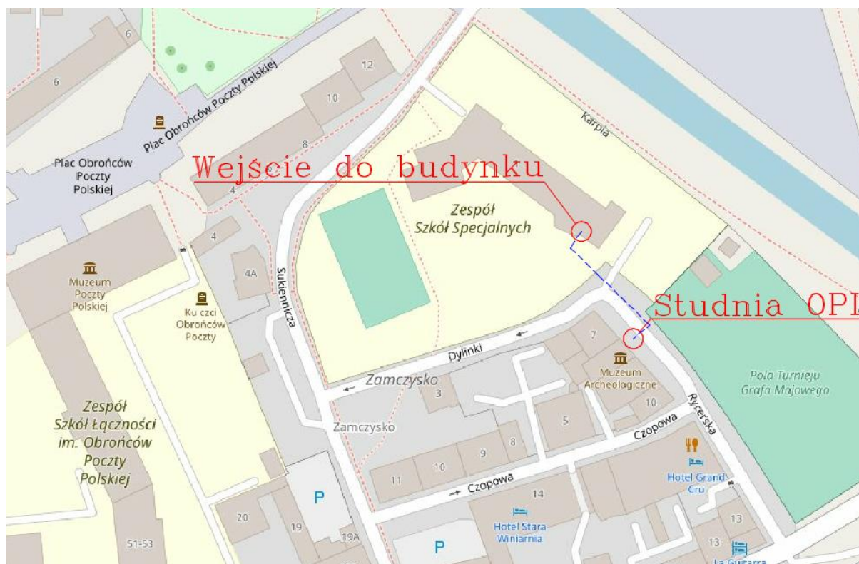
Rys. 2b. Poglądowa trasa przyłącza
