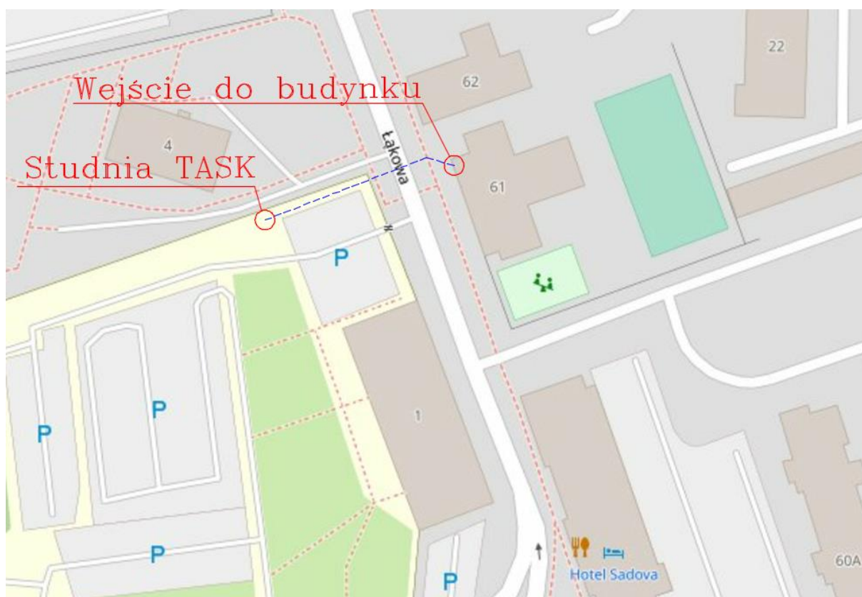
Rys. 11b. Poglądowa trasa przyłącza
